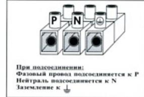
Воздушные завесы компании "OLEFINI S.A." с электрическим нагревом воздуха работают от трехфазной сети переменного тока 400 В, 50 Гц с заземлением. Кабель подключается к клеммам специальной пластиковой коробке, которая находится сверху тепловой завесы и имеет пять контактов.
