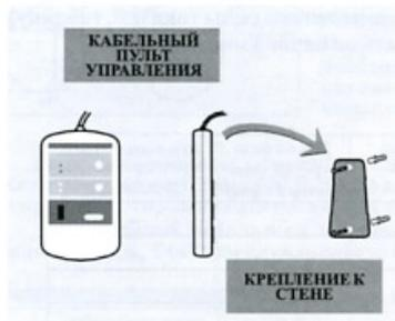
Все тепловые воздушные завесы компании "OLEFINI S.A." имеют кабельный пульт дистанционного управления, который нужно закрепить винтами, входящими в комплект поставки, на стене рядом с завесой.
